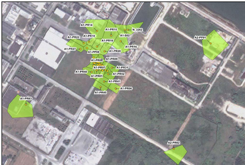
Figura 4.29. Nucleo di contaminazione da organoalogenati nei terreni saturi
