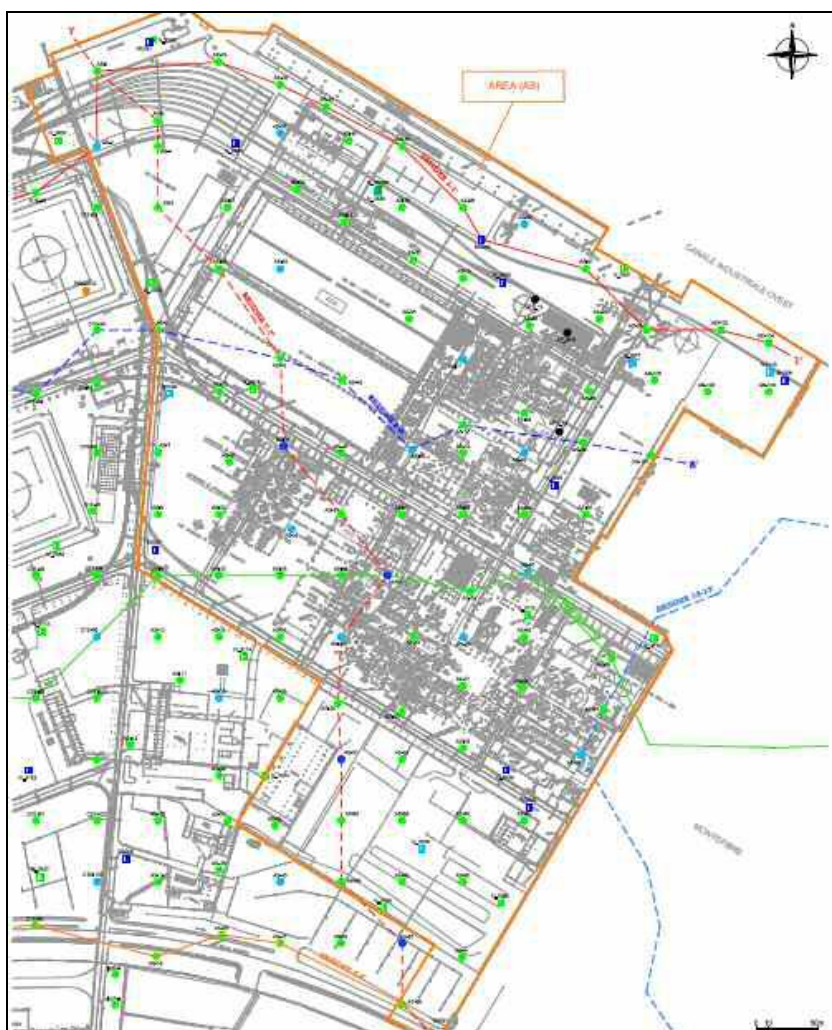
Figura 4.25. Sondaggi e piezometri eseguiti in area AS - sondaggi nel riporto (verde), piezometri nel riporto (azzurro), piezometri in prima falda (blu)
