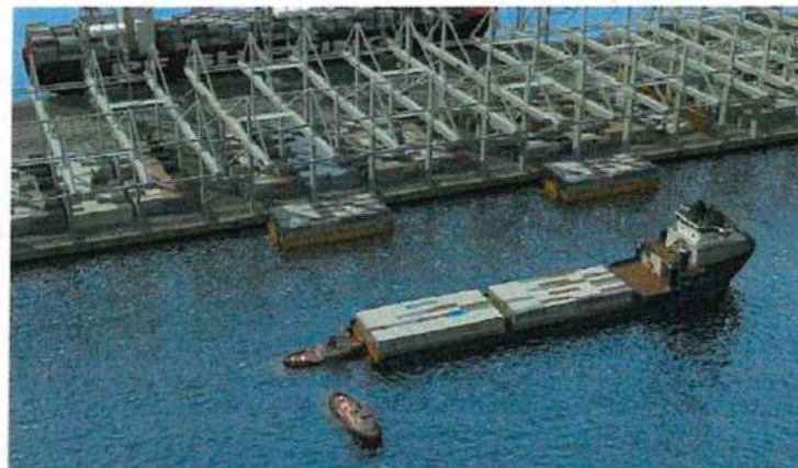
Figura 8: Caricamento delle chiatte su Mama Vessel . Fonte: Videoclip of Venice Container Terminal and Logistics Study – VNCL 2012.
