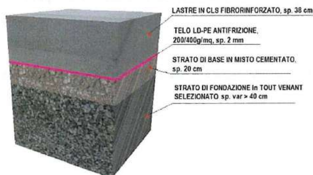
Figura 54: Schema stratigrafico della pavimentazione tipo 1: RIGIDA ( Quay e Hatch area).
