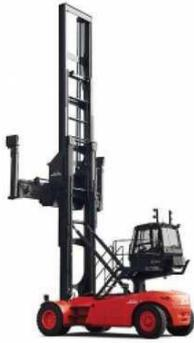
n. 2 Carrelli elevatori frontali per container vuoti (*Empty handler*): mezzi utilizzati nei depositi di container vuoti, riparatori di container e per terminal container con aree di stoccaggio vuoti. L'altezza di accatastamento va generalmente da 6 a 8 container. Dotato di *spreader* telescopico, assale anteriore extra largo per garantire stabilità in traslazione e in sollevamento, sistema di sollevamento ad alta velocità con pompe a portata variabile.
