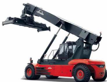
n. 1 Carrello elevatore (*Reach stacker*): mezzo per la movimentazione dei container all'interno delle aree di banchina, di stoccaggio e di movimentazione del terminal. Viene utilizzato per il trasporto rapido a brevi distanze e per l'accumulo sugli spazi dedicati. Il loro utilizzo è più flessibile e garantisce una maggiore velocità e capacità di accatastamento dei container rispetto ai carrelli elevatori.
