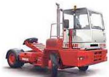
Treatore a ralla (*Tractor*): mezzo per la movimentazione dei container da un posto ad un altro dei piazzali o della banchina. Adibito al trasporto dei semirimorchi, o dei rimorchi, all'interno del terminal. È un trattore con velocità limitata a 40 km/h. Il piatto ralla è l'elemento della motrice che permette l'aggancio, il sollevamento ed il trasporto del rimorchio o del semirimorchio.
