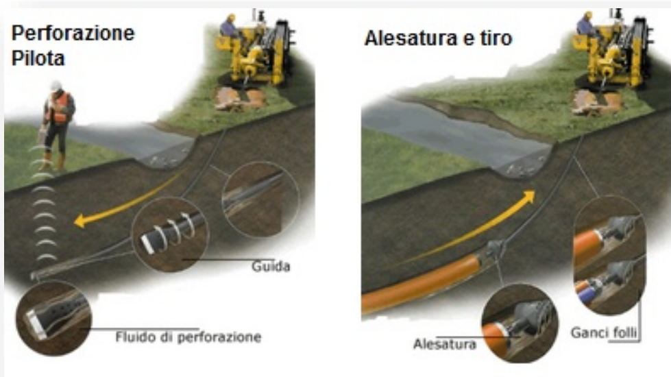
Figura 21 - tecnologia di trivellazione orizzontale controllata (TOC)
