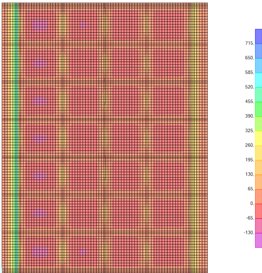
Figura 7-21 - Diagramma di momento flettente di progetto M_{11} [kNm] per fase di cavo dell'onda.
