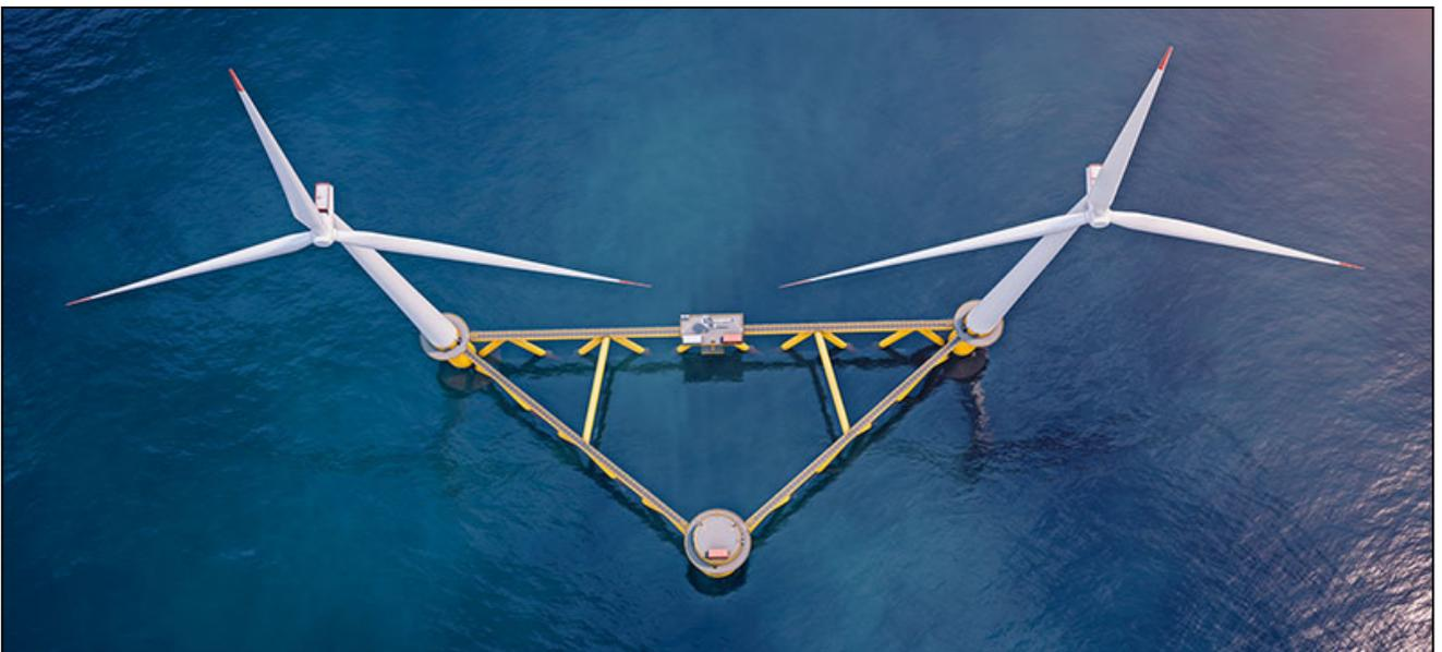
Figura 5: Struttura di fondazione galleggiante con doppio aerogeneratore.
