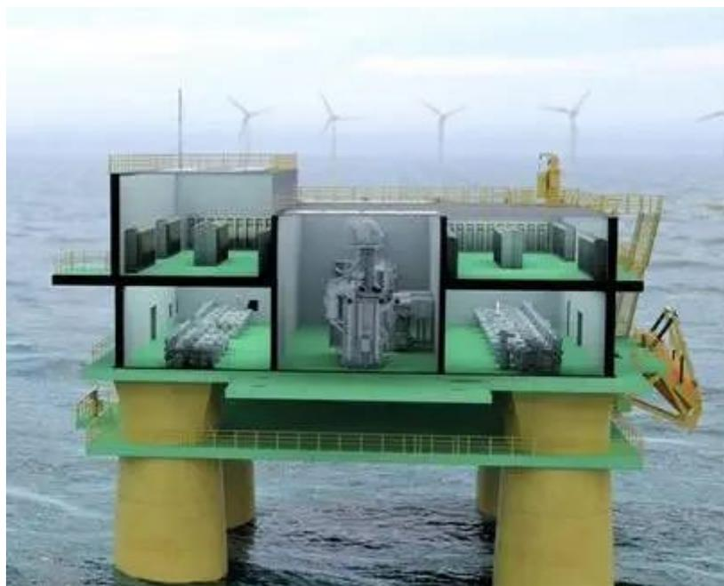
Figura 6: Esempio di stazione HVDC floating di trasformazione e conversione 150/500 kV.
