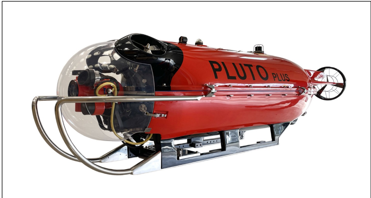
Figura 6: Esempio di Veicolo filoguidato (ROV), Pluto Plus di Gaymarine.
