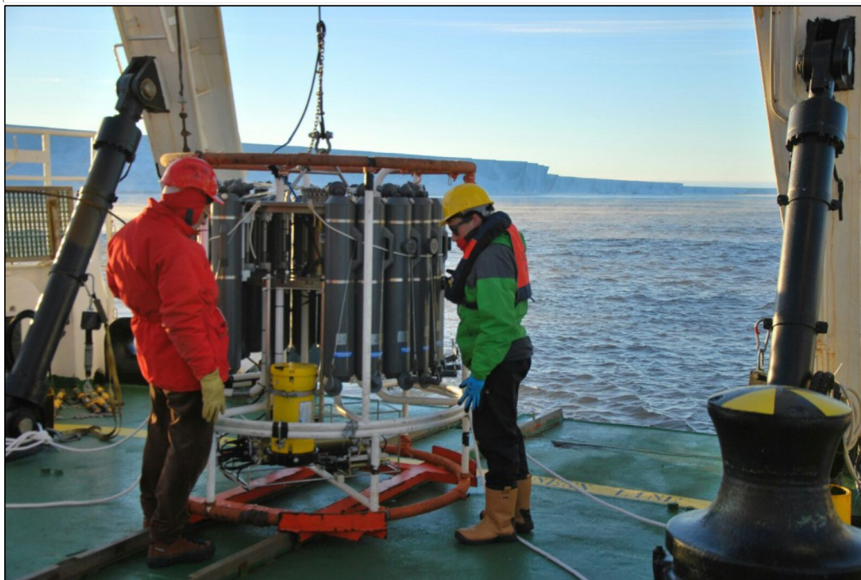
Figura 3: Campionatore d'acqua (rosetta) con sonda multiparametrica.
