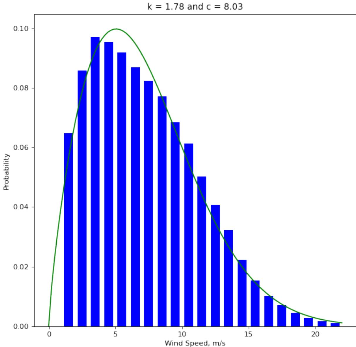
**Figura 4: Distribuzione di Weibull della probabilità della velocità del vento all'altezza del mozzo (177 m su MSL).**
