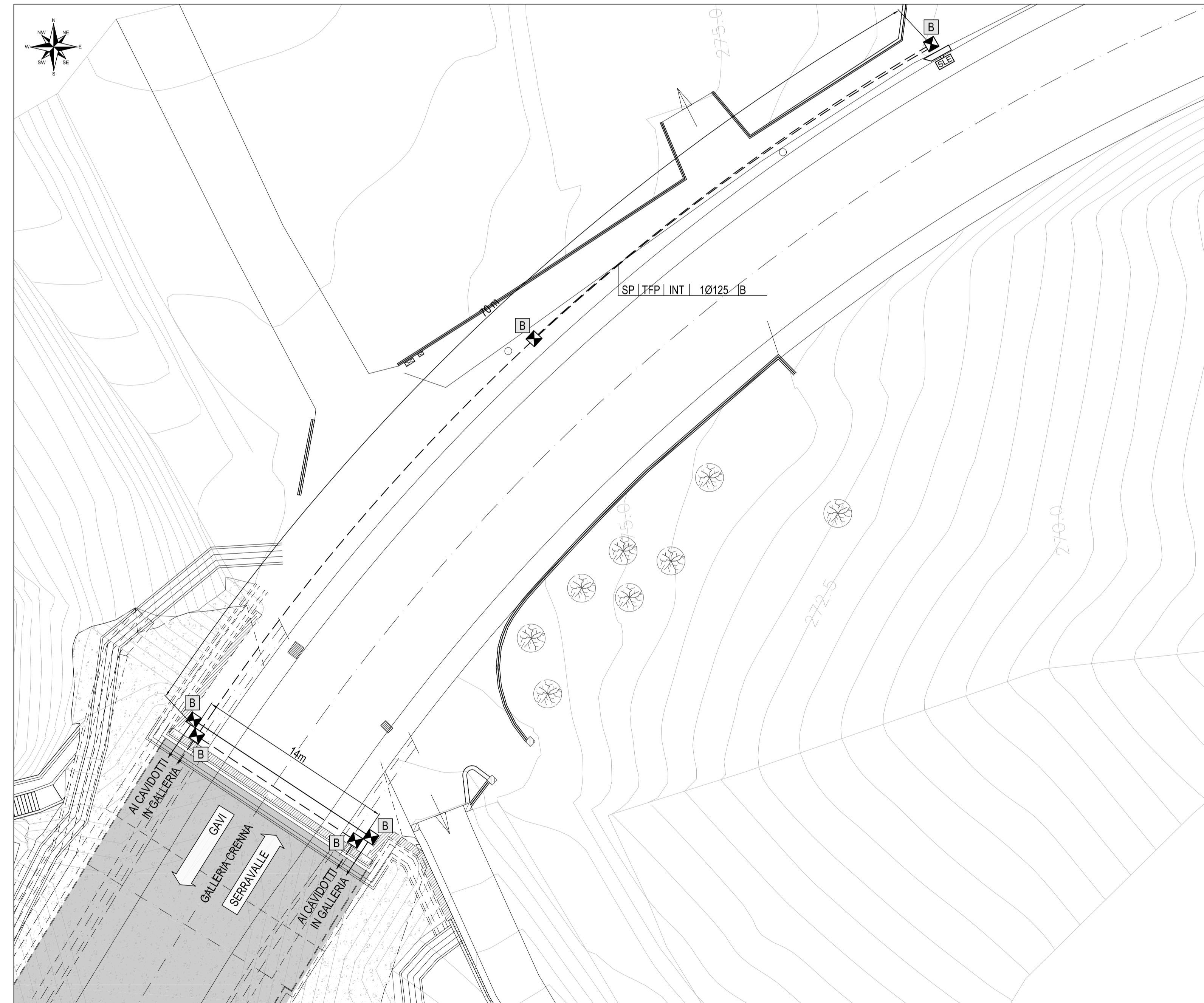
DISPOSIZIONE CAVIDOTTI IMBOCCO LATO SERRAVALLE - SCALA 1:200
