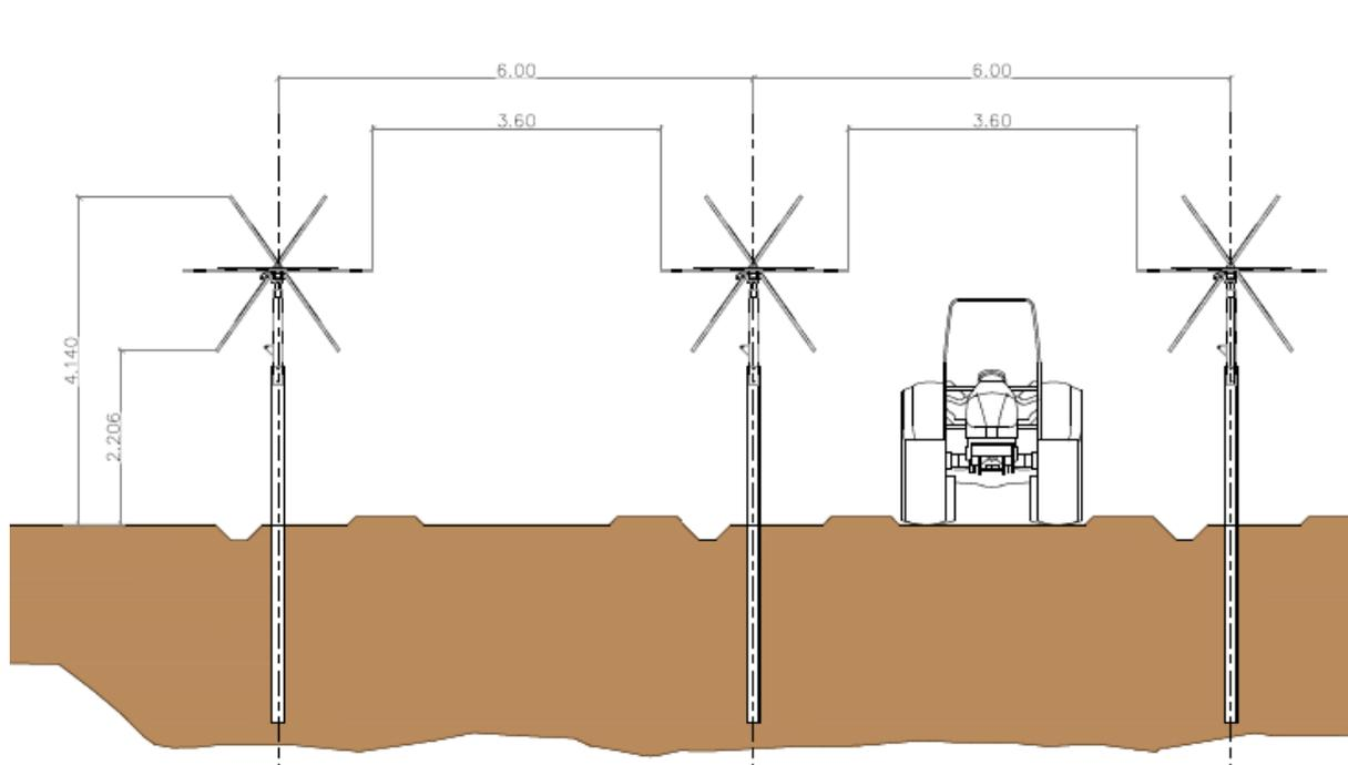
Sezione struttura sostegno moduli con palo di fondazione che raggiunge una profondità di 2 m. Altezza minima da terra 2,2 m, altezza massima da terra 4,14 m
