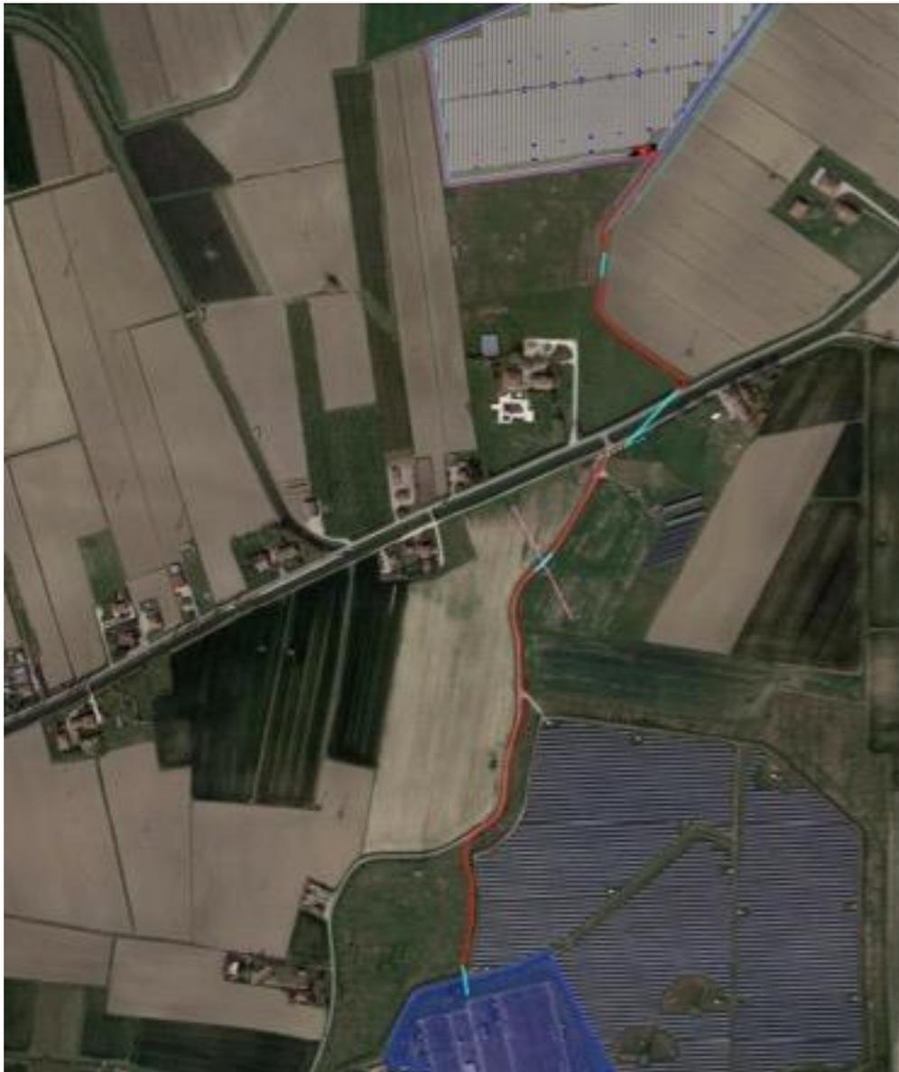
Figura 10 - Nell'immagine sopra, è rappresentata la rete di connessione AT in In rosso i tratti posati con scavo a cielo aperto, in azzurro con T.O.C.
