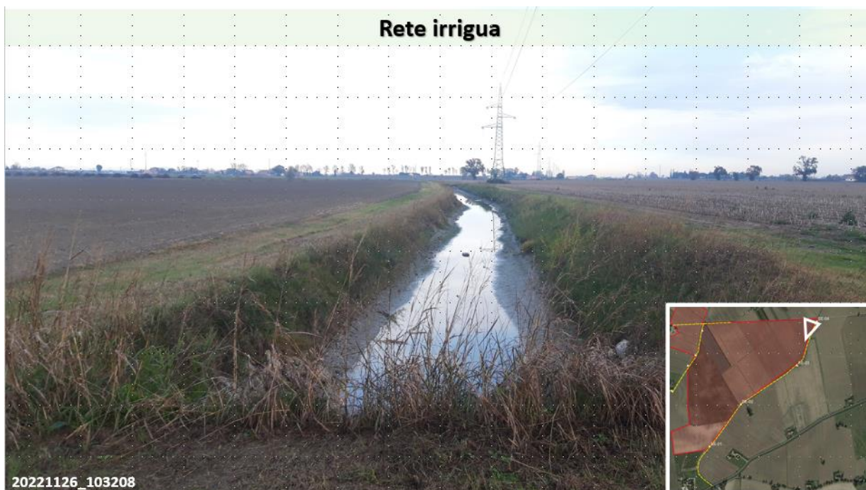
Figura 54: aspetto tipico e rappresentativo dei canali irrigui, alveo regolare e pendenze limitatissime e sponde inclinate mantenute con copertura erbosa.
