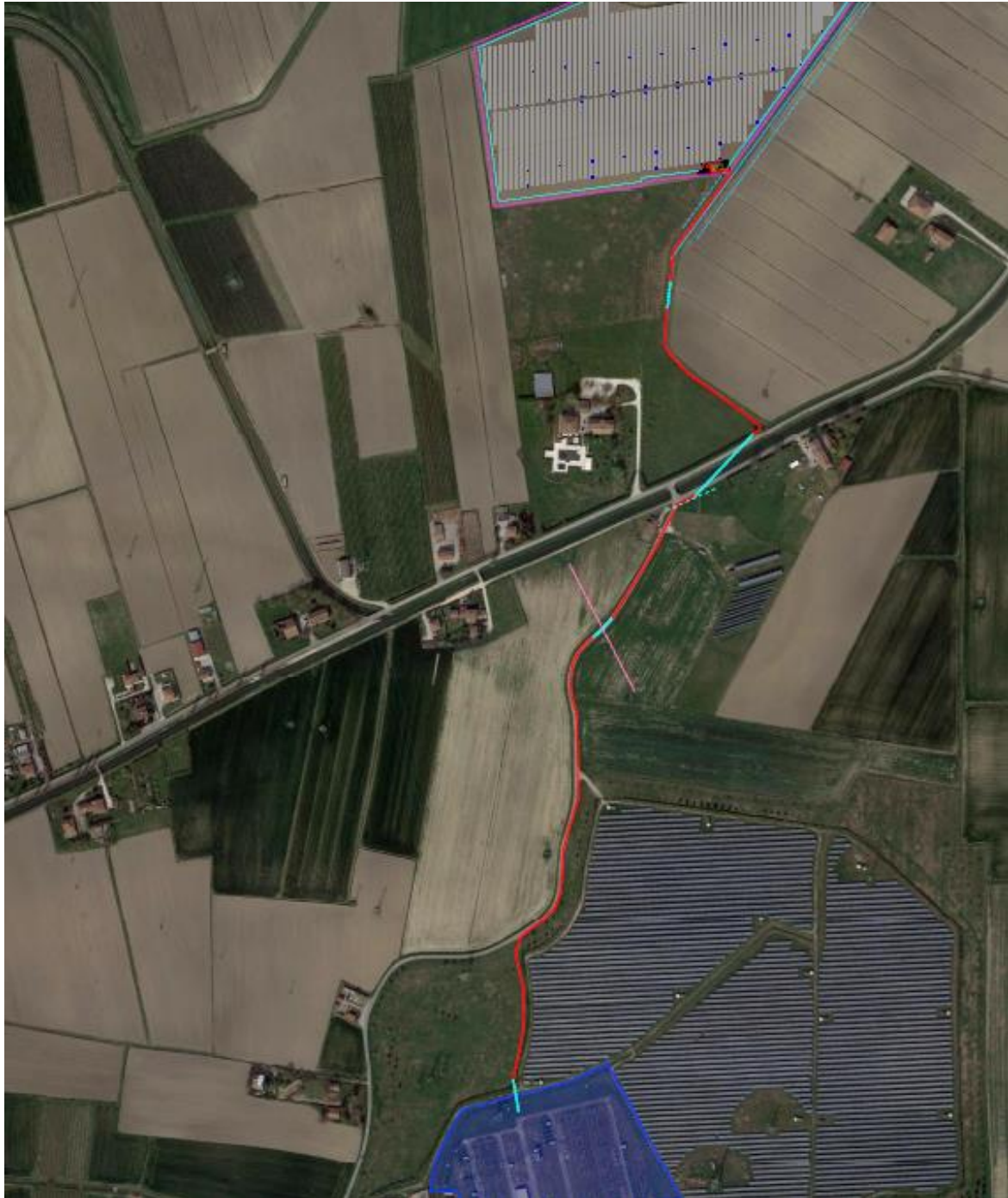
Figura 8 – Nell'immagine sopra, è rappresentata la rete di connessione AT. In rosso i tratti posati con scavo a cielo aperto, in azzurro con T.O.C.
