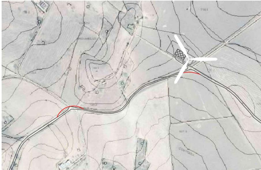
Fig 23 – Allargamento serie di curve lungo la strada vicinale del Pero – Firricchia presso la località C/da casale
