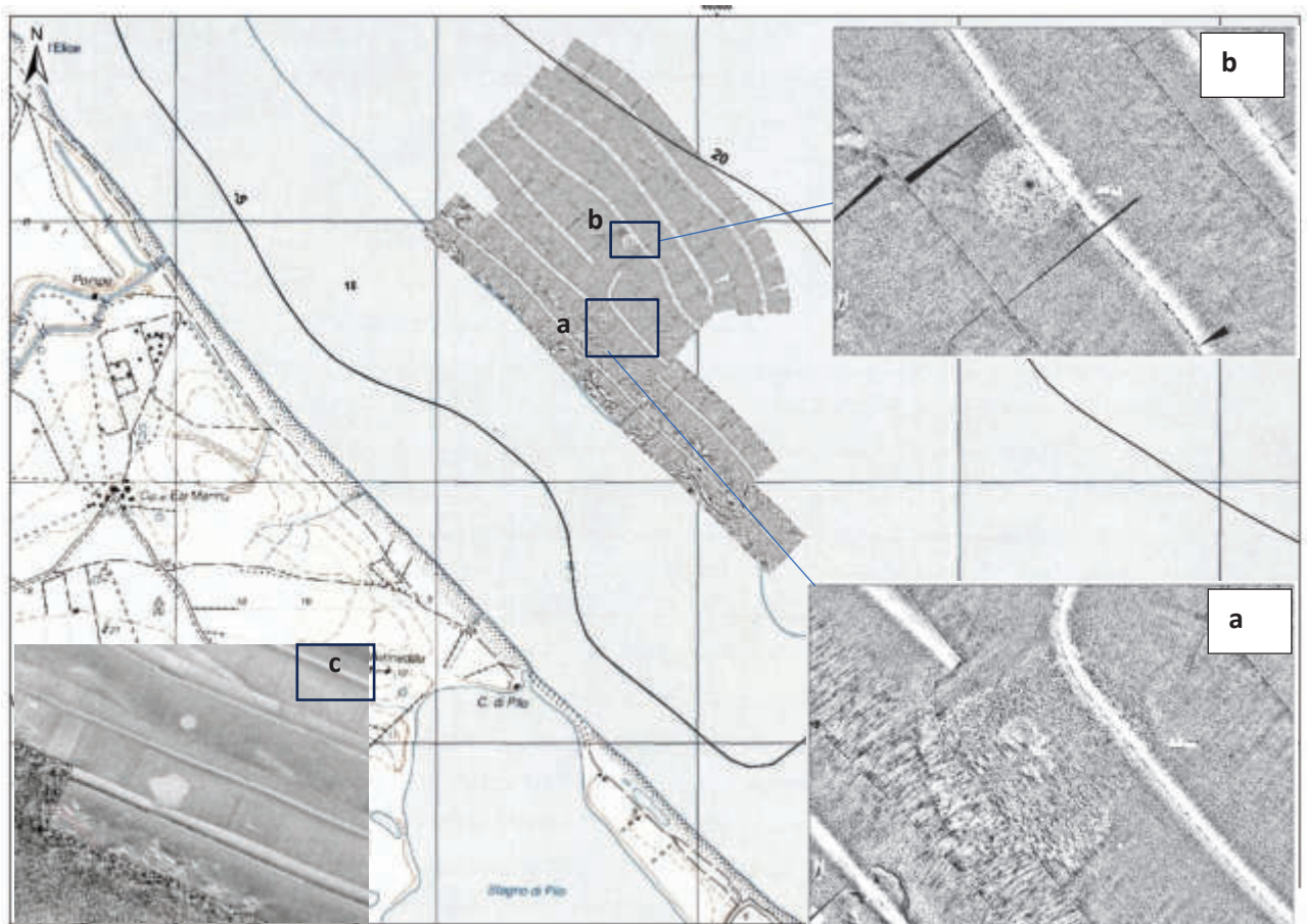
Fig. 8 – Tracciato SideScanSonar del 2021. Nei riquadri a e b spot delle aree ritenute potenzialmente idonee al trapianto. In c uno spot dal SSS del M.A.T.T.M. - SiDiMar., 2008
