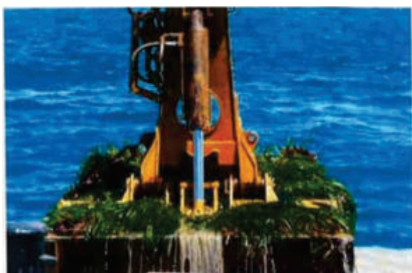
Figura 2 – Benna bivalve idraulica (da relazione Bedini 2014)
