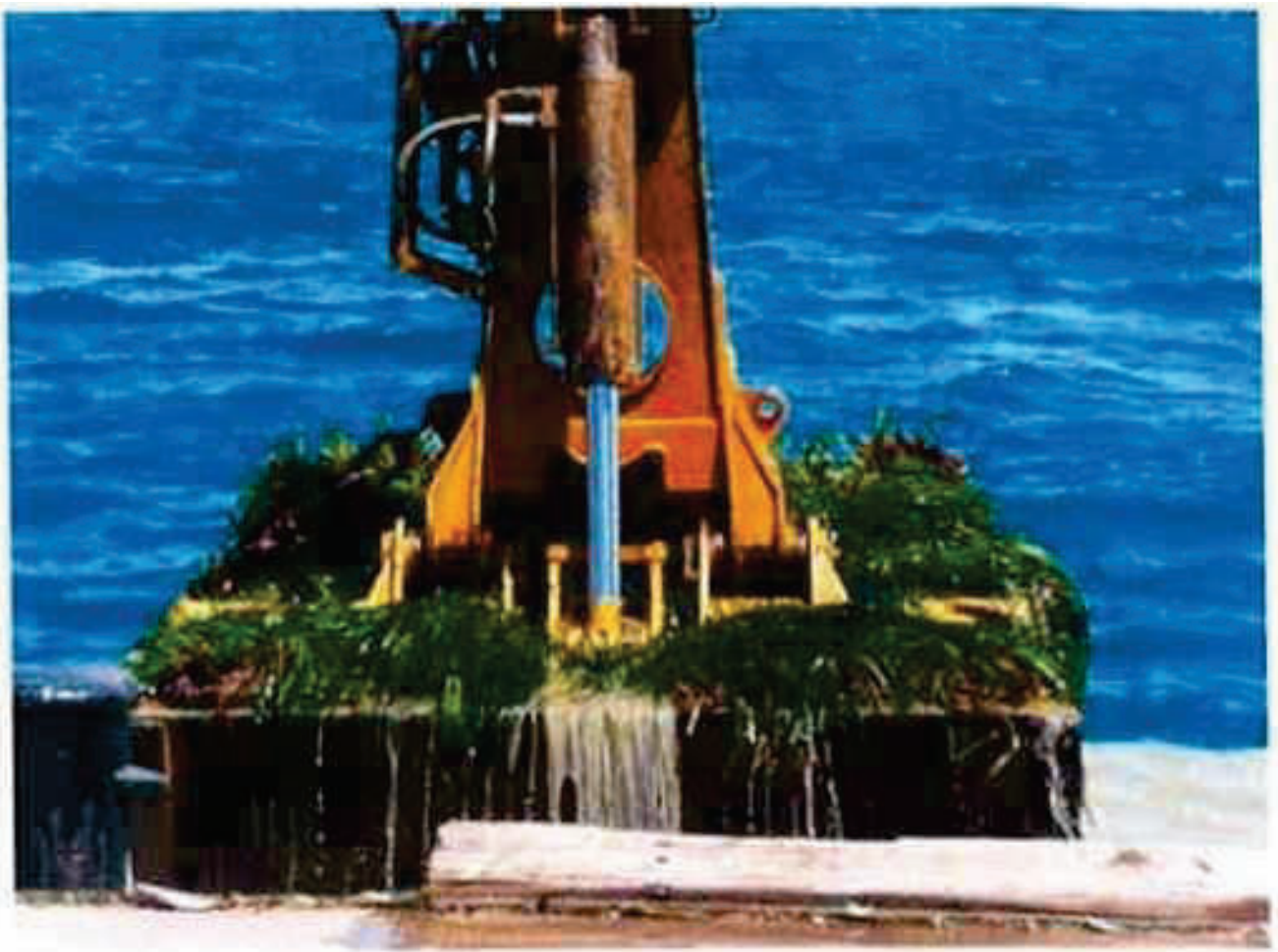
Figura 27 – Benna bivalve idraulica (da relazione Bedini 2014)
