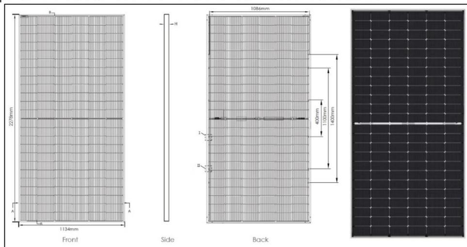
FIGURA 1 PANNELLO FV PARI A 570 WP – IN CONDIZIONI STANDARD - CON DIMENSIONI 2278 × 1134 × 30 MM
