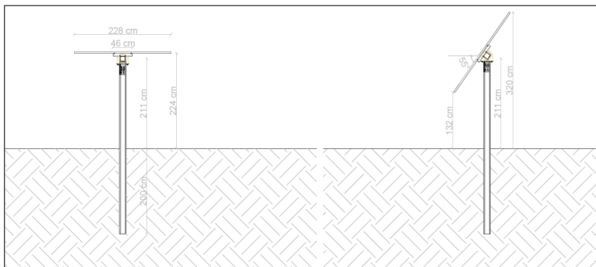
FIGURA 31 – TRACKER TIPO AD ASSE VARIABILE
