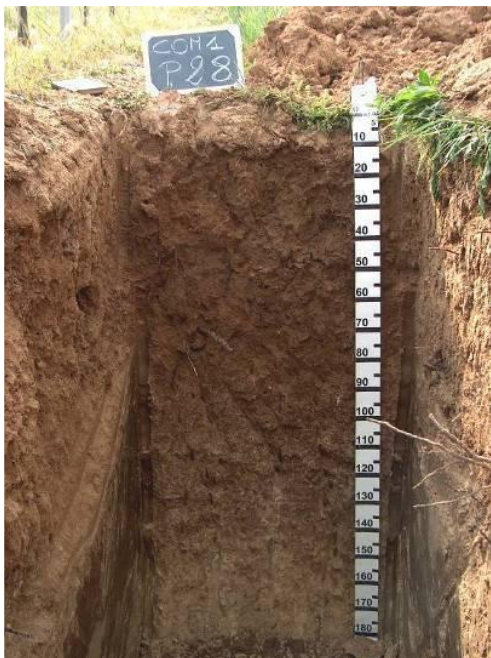
FIGURA 5 – ESEMPIO DI TRINCEA – FONTE: (ISPRA, 2010)
