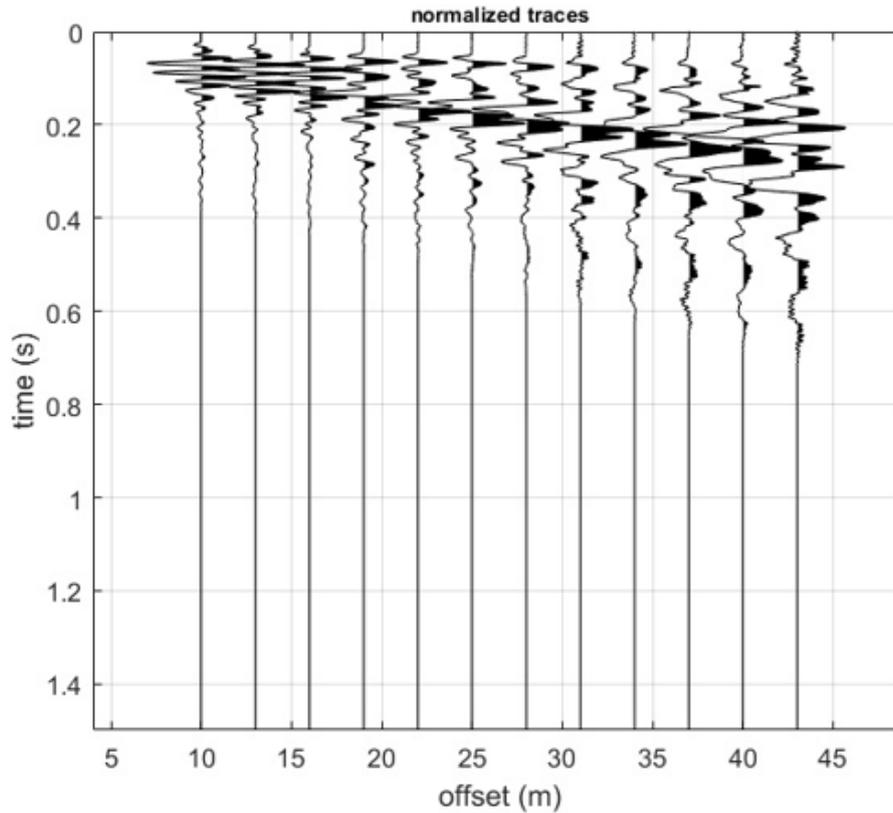
**Figura 11**-Tracce acquisite in situ ed utilizzate per la costruzione dello spettro di velocità
