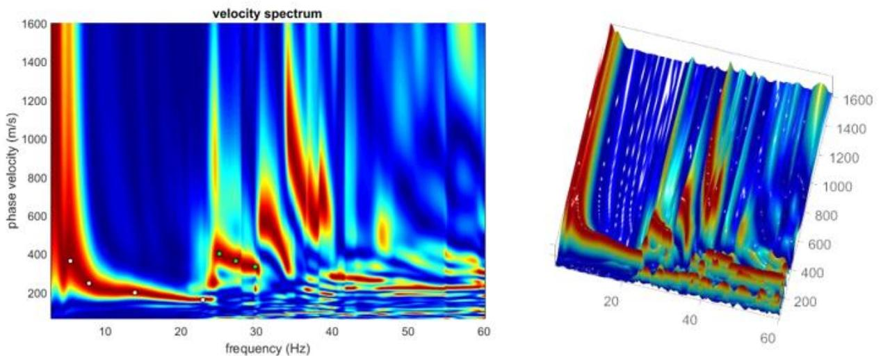
**Figura 12**-Spettro di velocità (visualizzazione 2D e 3D). In evidenza l'andamento del modo fondamentale (pallini bianchi) e del primo modo superiore (pallini verdi)
