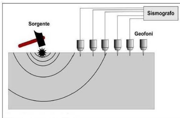
**Figura 10**-Schema realizzativo indagine MASW (Onde di Rayleigh)
