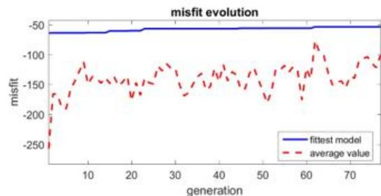
Figura 16-Evoluzione del misfit (disaccordo) al progredire dei modelli testati durante il processo di inversione
