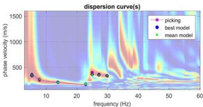
Figura 15-Curva di dispersione osservata (picking pallini fucsia) e curve di dispersione relative "best model" (pallini blu) e "mean model" (croci verdi)
