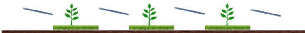
Figura 22: Sistema agrivoltaico in cui la coltivazione avviene tra le file dei moduli fotovoltaici, e non al di sotto di essi (TIPO 2).
