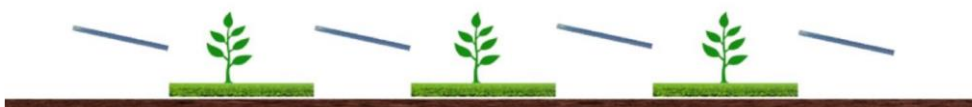
Figura 23: Sistema agrivoltaico in cui i moduli fotovoltaici sono disposti verticalmente. La coltivazione avviene tra le file dei moduli fotovoltaici, l’altezza minima dei moduli da terra influenza il possibile passaggio di animali (TIPO 3).
