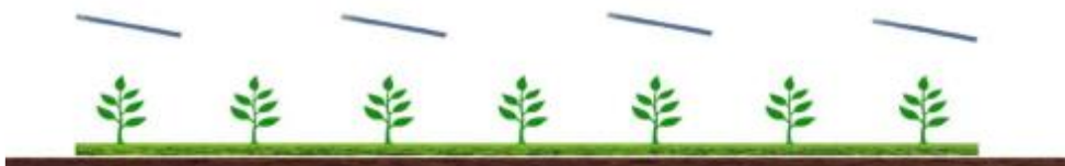
Figura 21: Sistema agrivoltaico in cui la coltivazione avviene tra le file dei moduli fotovoltaici, e sotto a essi (TIPO 1).
