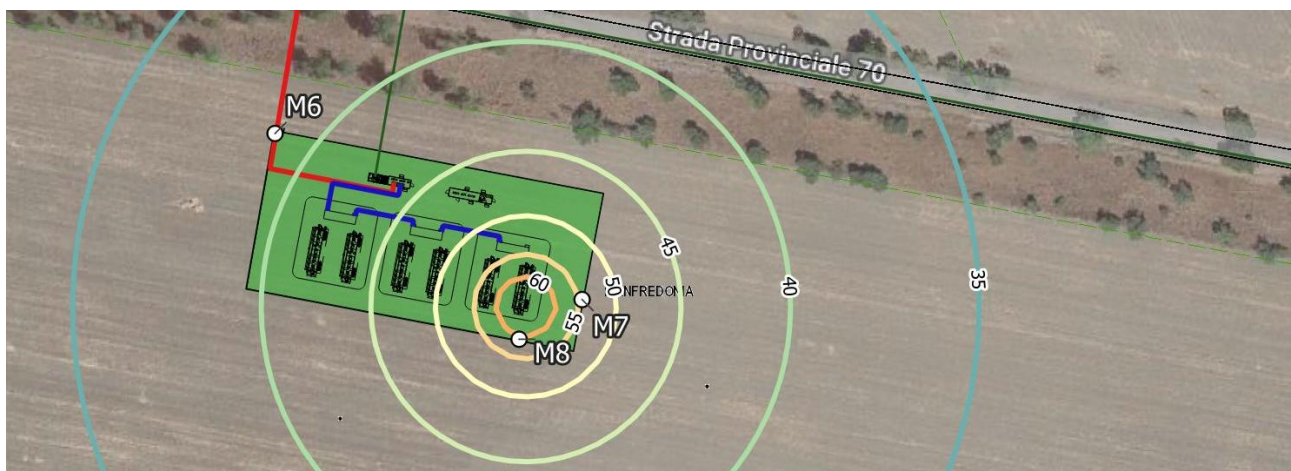
Figura 3: Isofonia di emissione della sorgente "unità di climatizzazione"
