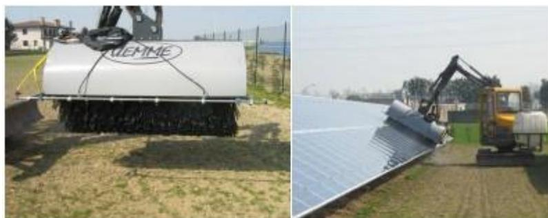
*Figura 17: Dispositivo di pulizia moduli – Pulizia dei moduli*
