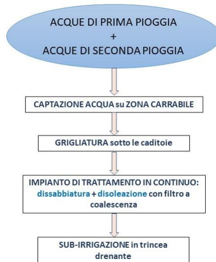
**Figura 5. 1 Diagramma di flusso trattamento acque**
