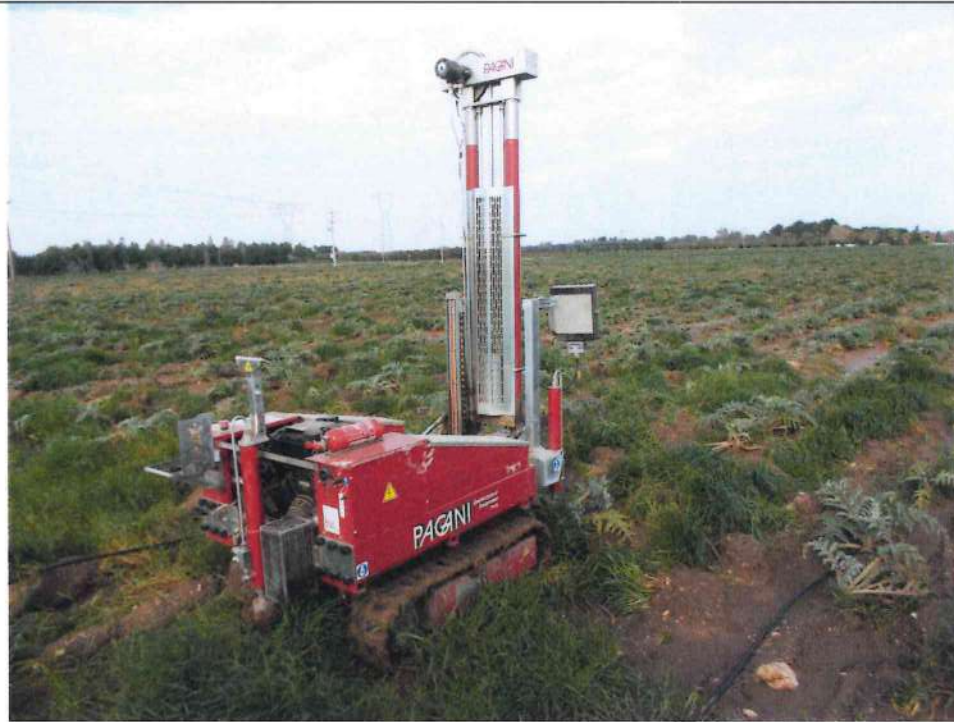
Esecuzione prova DPSH 2
