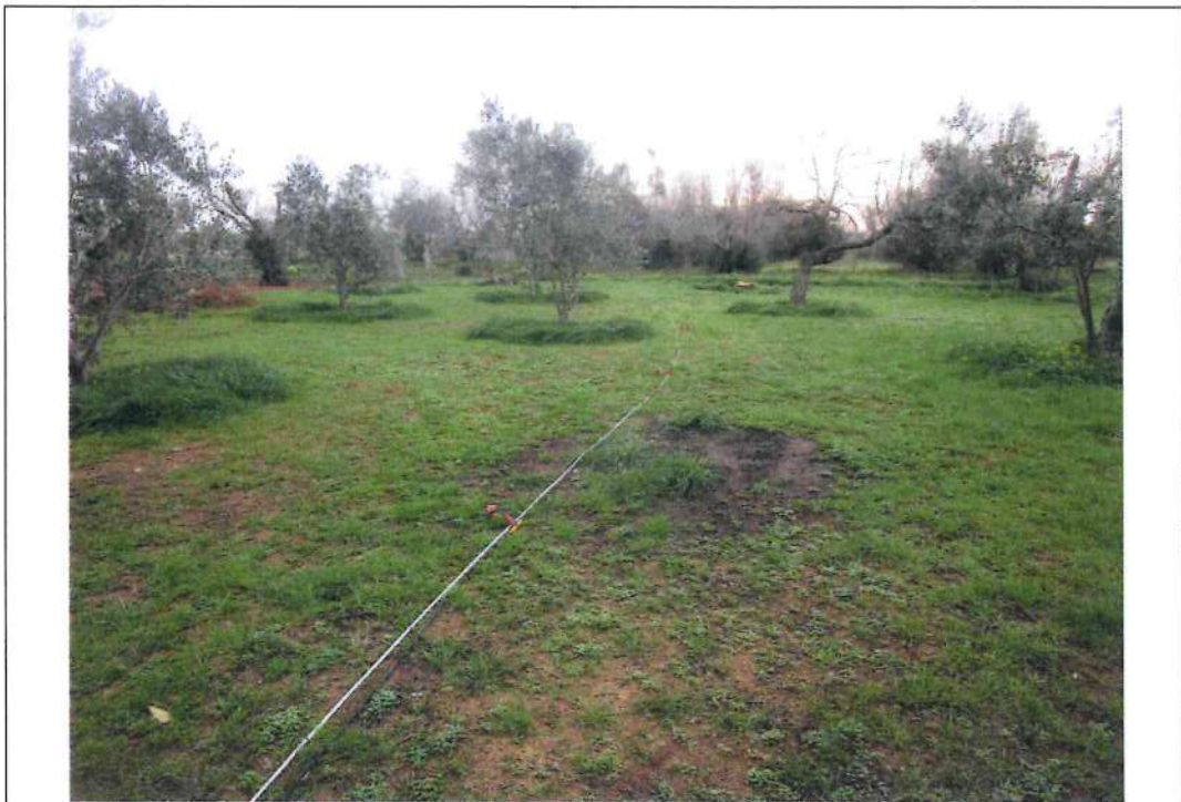
Esecuzione sismica a rifrazione
