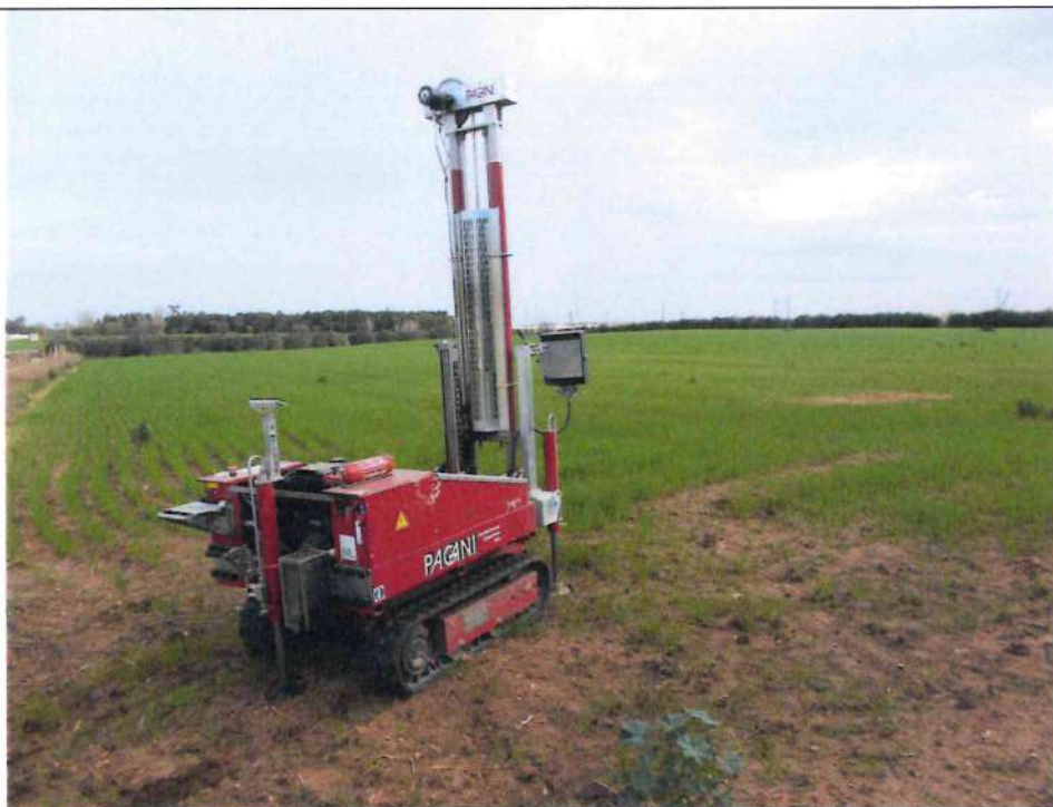
Esecuzione prova DPSH 5
