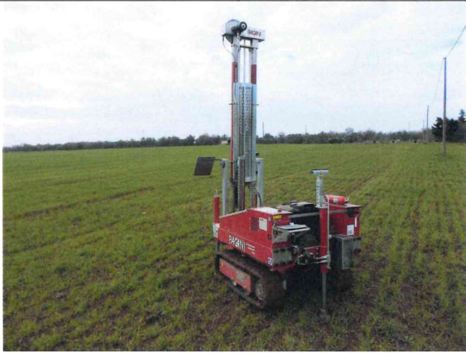
Esecuzione prova DPSH 1
