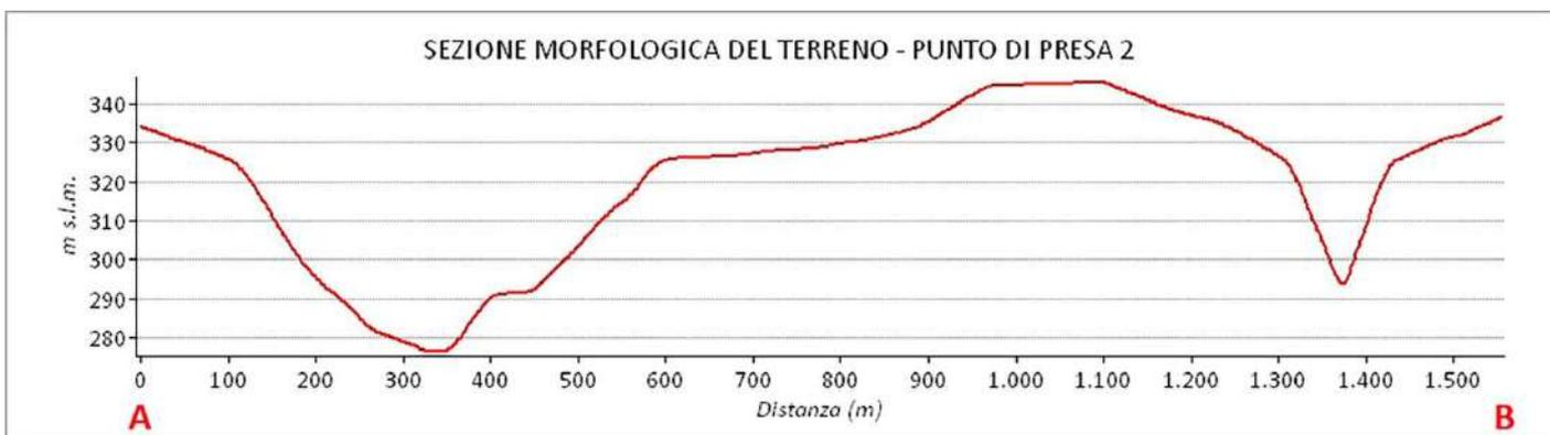
Figura 10 - Sezione morfologica del terreno del punto di presa 2
