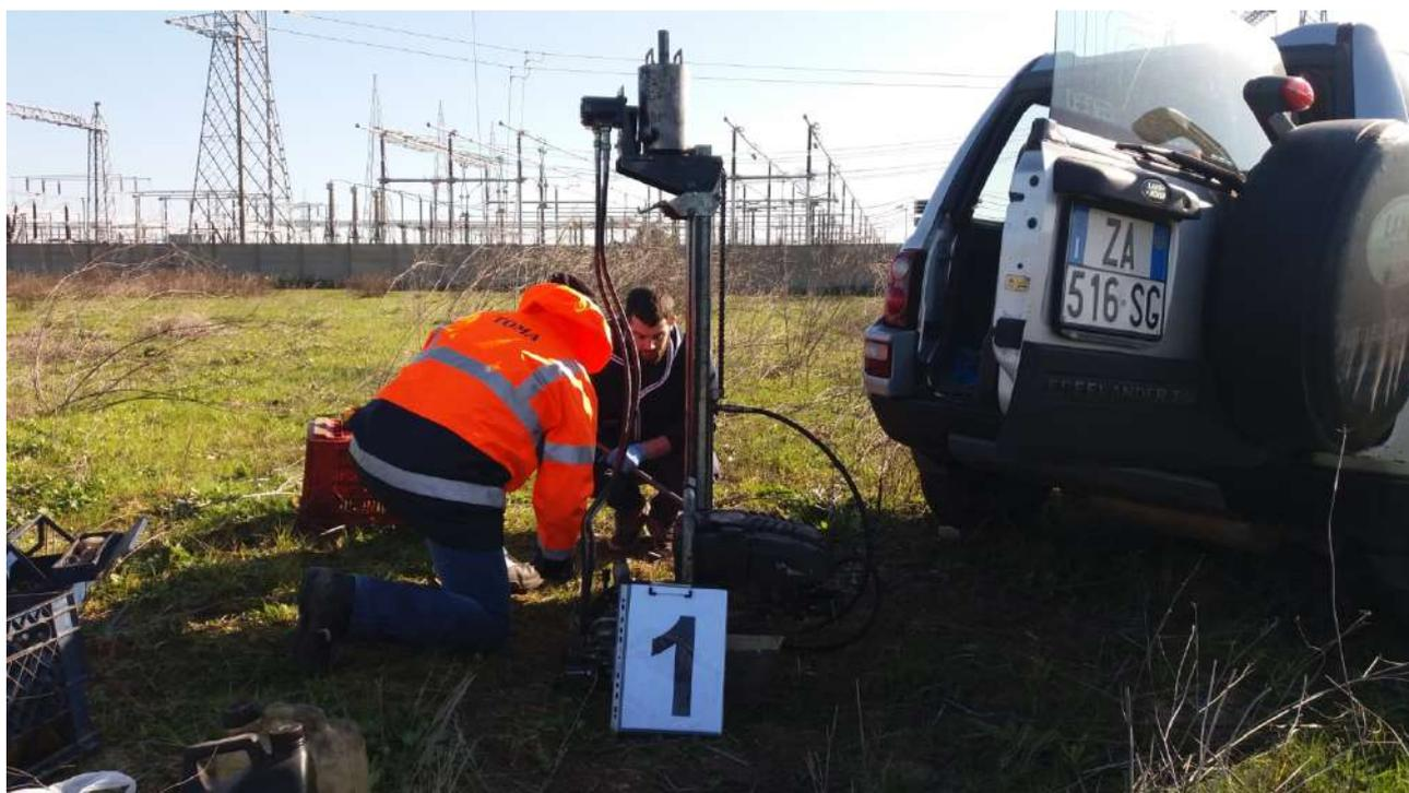
Prova Penetrometrica Dinamica denominata **DIN2**
