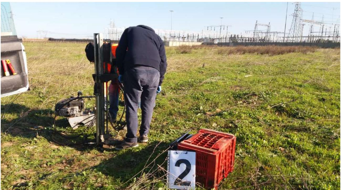
Rilievo sismico a rifrazione in onda P e prospezione sismica in onda S
