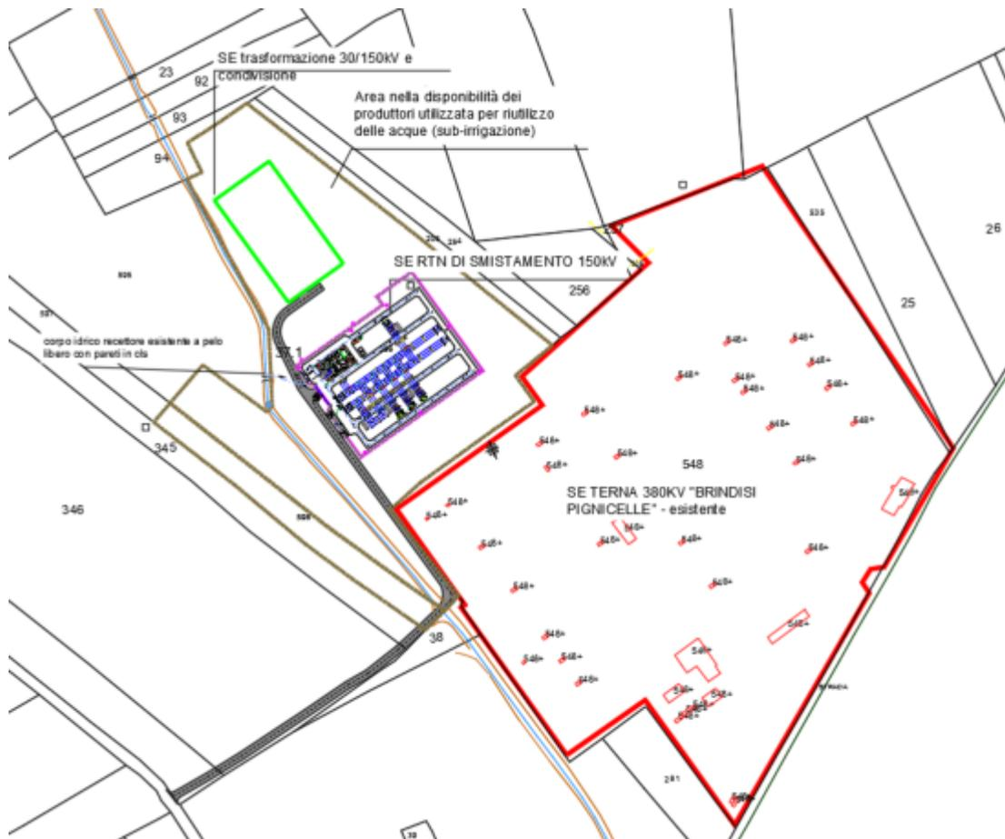
Figura 5: Inquadramento catastale dell'area destinata alla stazione utenza e stazione di smistamento
