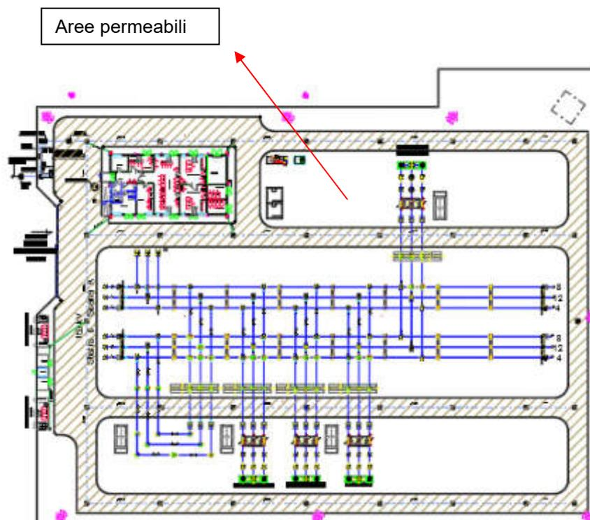
Figura 2: Le aree non tratteggiate sono escluse dal calcolo delle portate poiché aree sterrate o con pietrisco.
