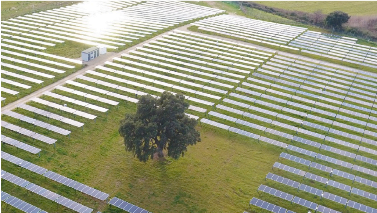
Figura 3 – esempio di impianto realizzato con i tracker proposti e pannelli in configurazione monofilare
