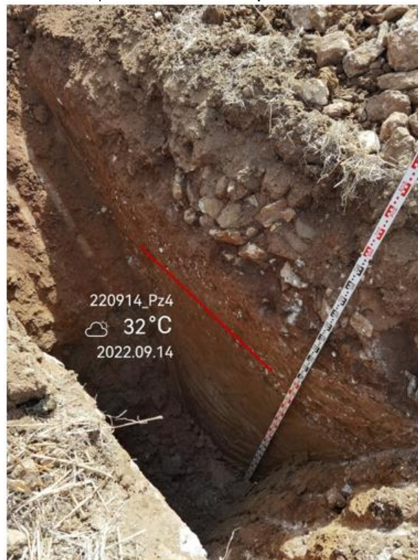
Foto 7: Saggi di scavo 220914_Pz4. In evidenza i limiti di strato
