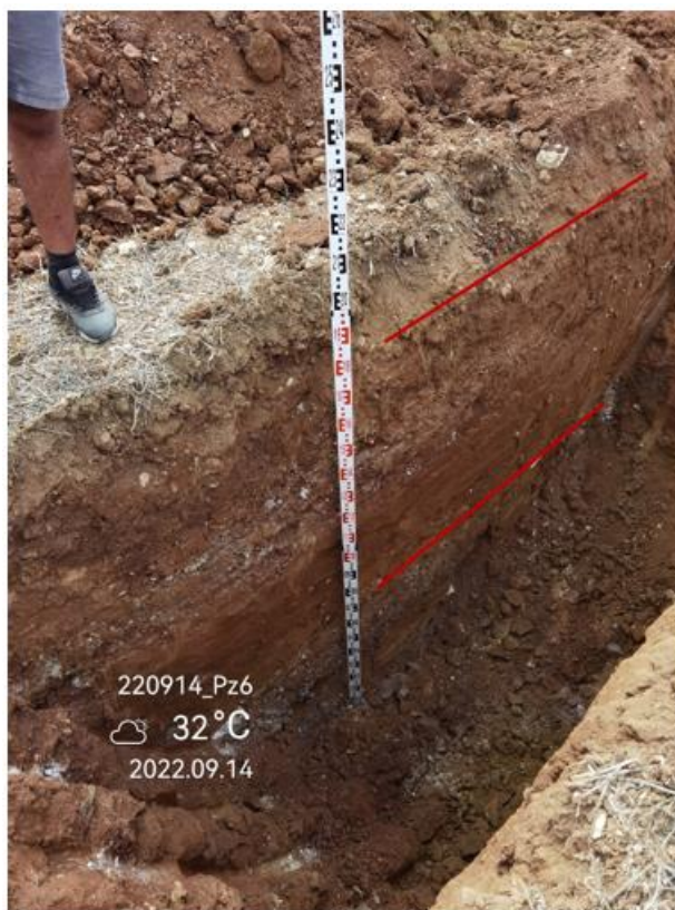
Foto 8: Saggi di scavo 220914_Pz6. In evidenza i limiti di strato
