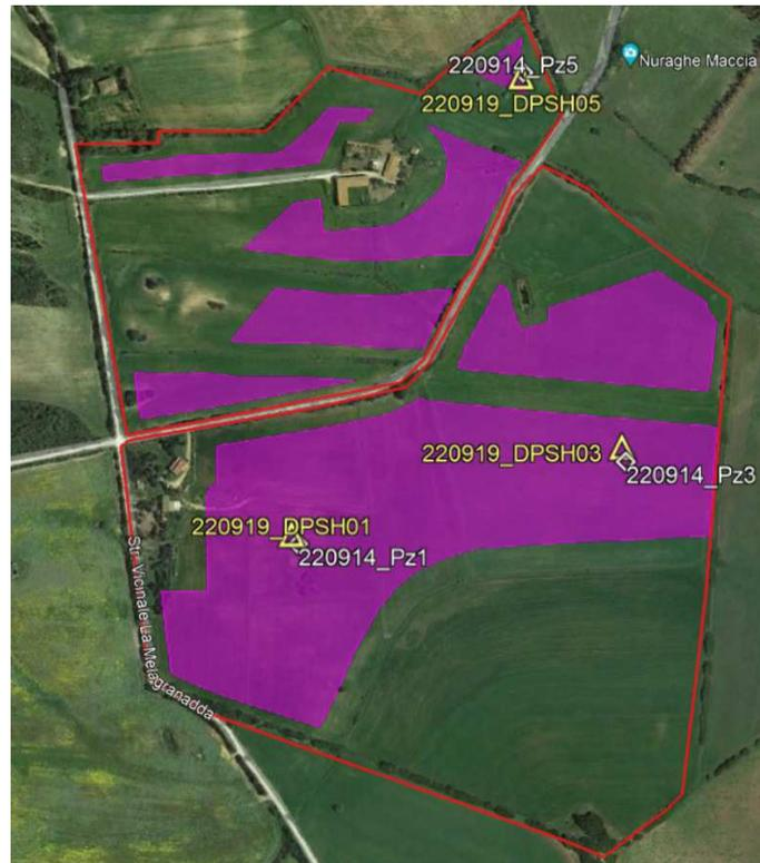
La caratterizzazione dell'area è stata resa possibile dalla realizzazione di tre saggi di scavo: 220914\_Pz1, 220914\_Pz2 e 220914\_Pz3, oltre che con l'esecuzione di tre prove penetrometriche dinamiche: 220914\_DPSH01, 220914\_DPSH02 e 220914\_DPSH03. Nell'area si rilevano tre strati così distinti dall'alto verso il basso:
