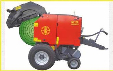
Vista laterale macchina con ballone a centro morbido formato in camera fissa a catena e traversine
