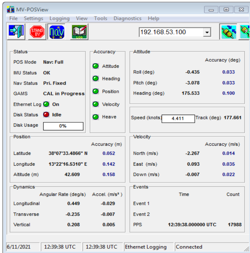
Figura 3.3.3.1 Schermata di controllo dell’APPLANIX con parametri di qualità sul posizionamento e assetto
