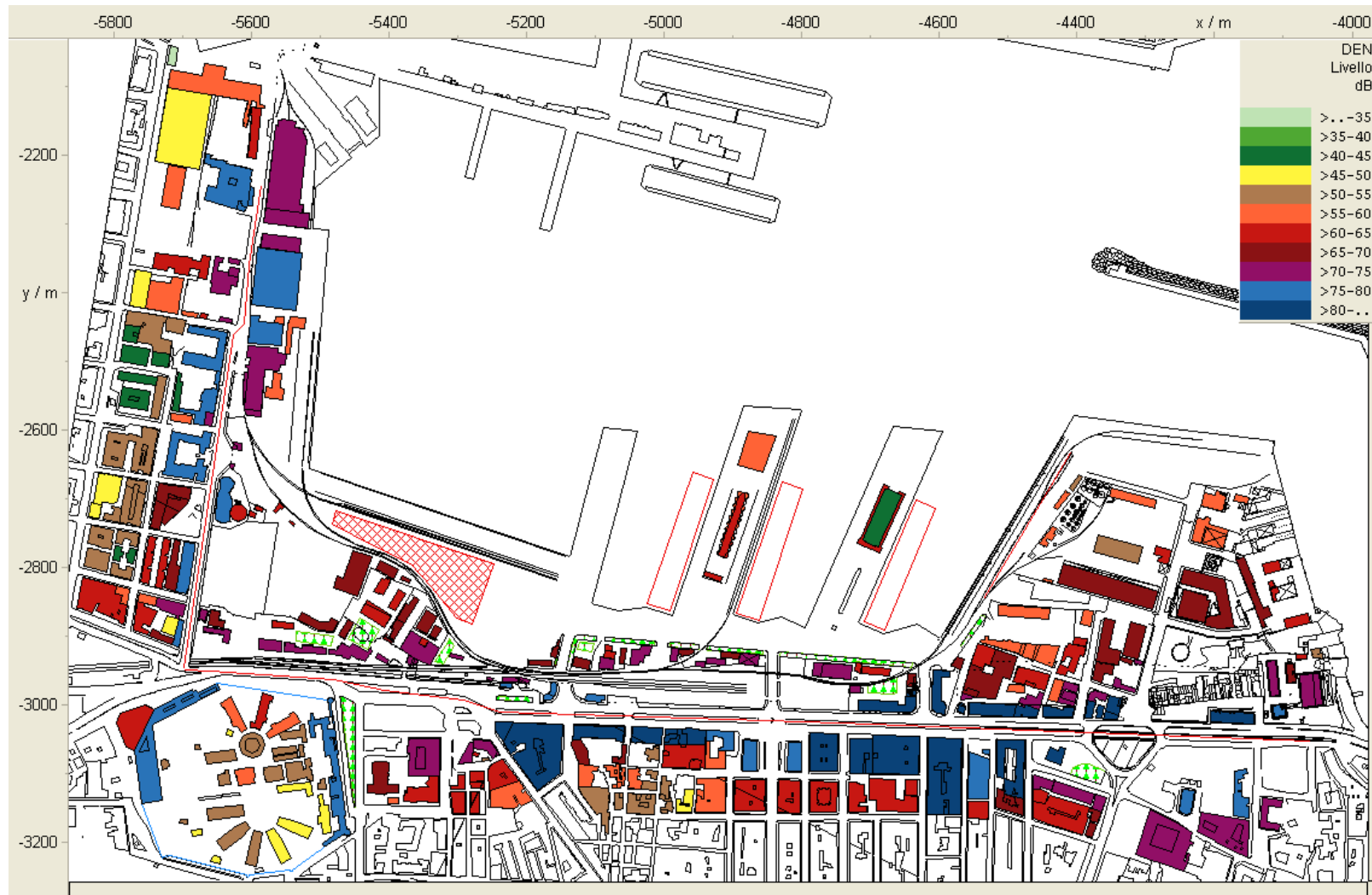
Mappa L DEN , livelli di facciata, simulazione “ Stato acustico reale ” (Fonte: IMMI).
