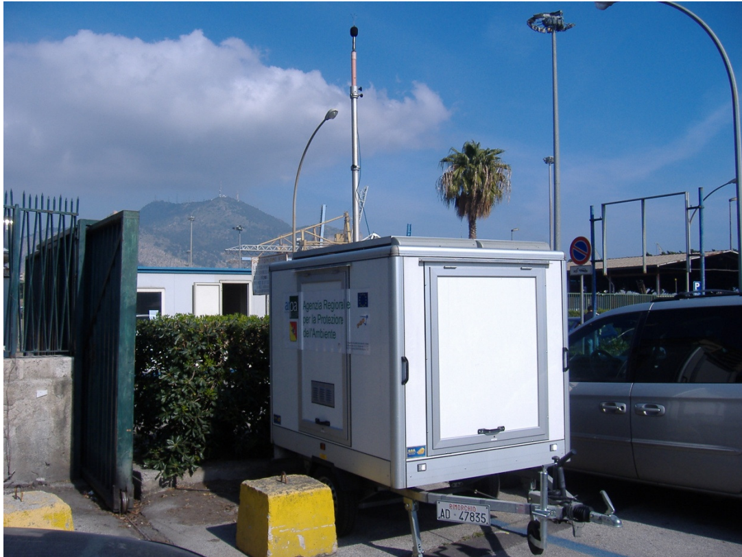
Fotografia del carrello equipaggiato di centralina di rilevamento fonometrico.
