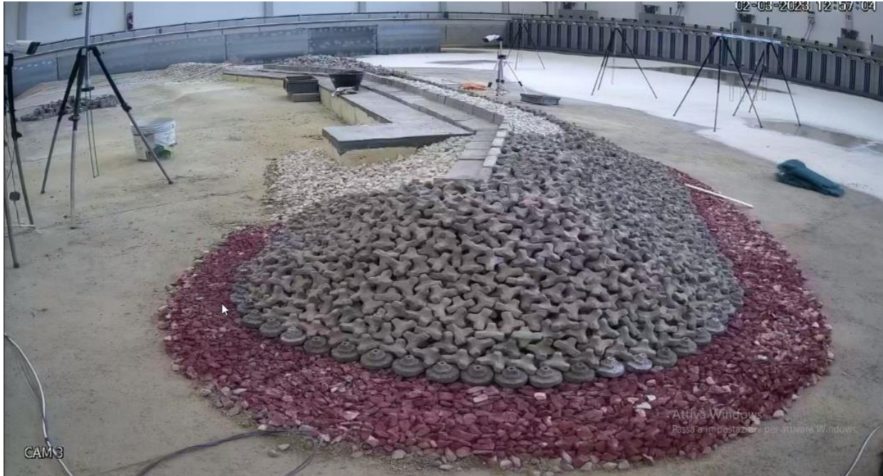
Figura 7-3: Modellazione fisica 3D presso la vasca del laboratorio EUMER di UniSalento
