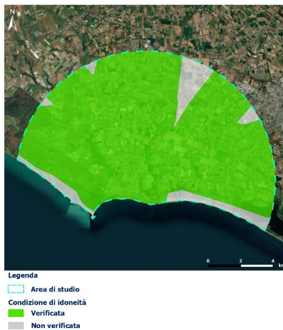
Figura 3-25 Seconda condizione di idoneità: aree poste ad una distanza massima di 1.500 metri da linee elettriche esistenti
