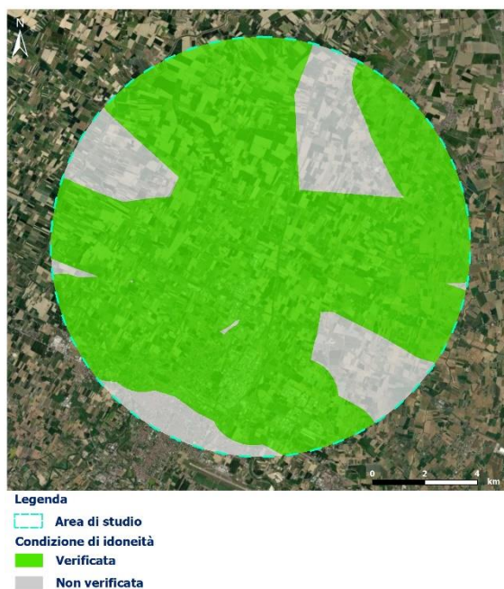
Figura 3-53 Seconda condizione di idoneità: aree poste ad una distanza massima di 1.500 metri da linee elettriche esistenti
