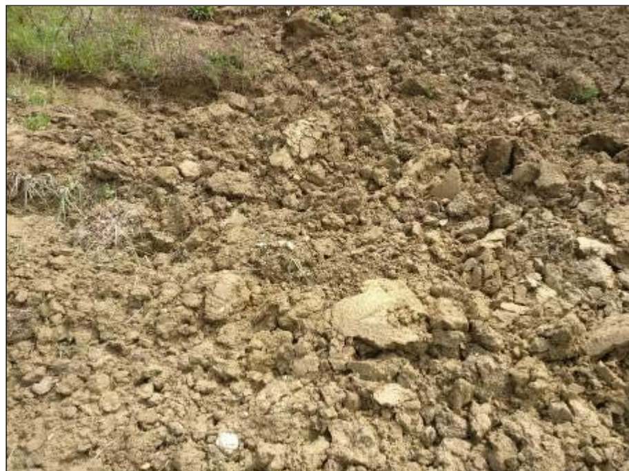
Figura 3.18 - Depositi fluvio-lacustri rimaneggiati visibili su alcuni scassi localizzati presso il Ramo D
