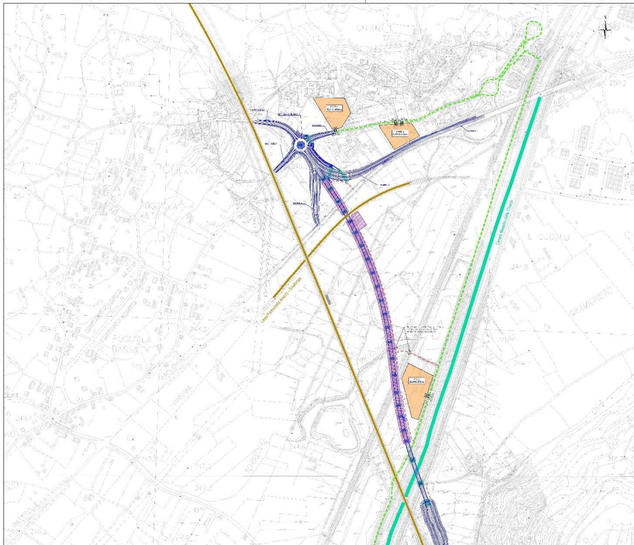
Figura 2.26 – MICROFASE 1B - Realizzazione strada di collegamento tra San Zeno e il raccordo autostradale Arezzo-Battifolle
