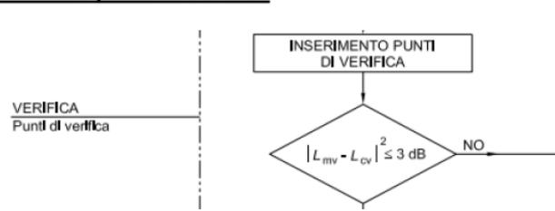
Figura 3-3 schema a blocchi taratura secondo UNI 11143-1 2005.
