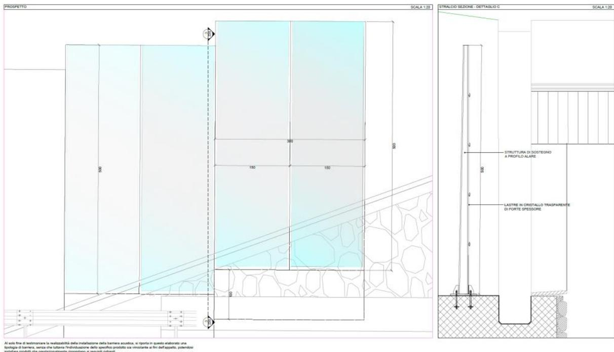
Figura 3-5 Particolare di una barriera.
