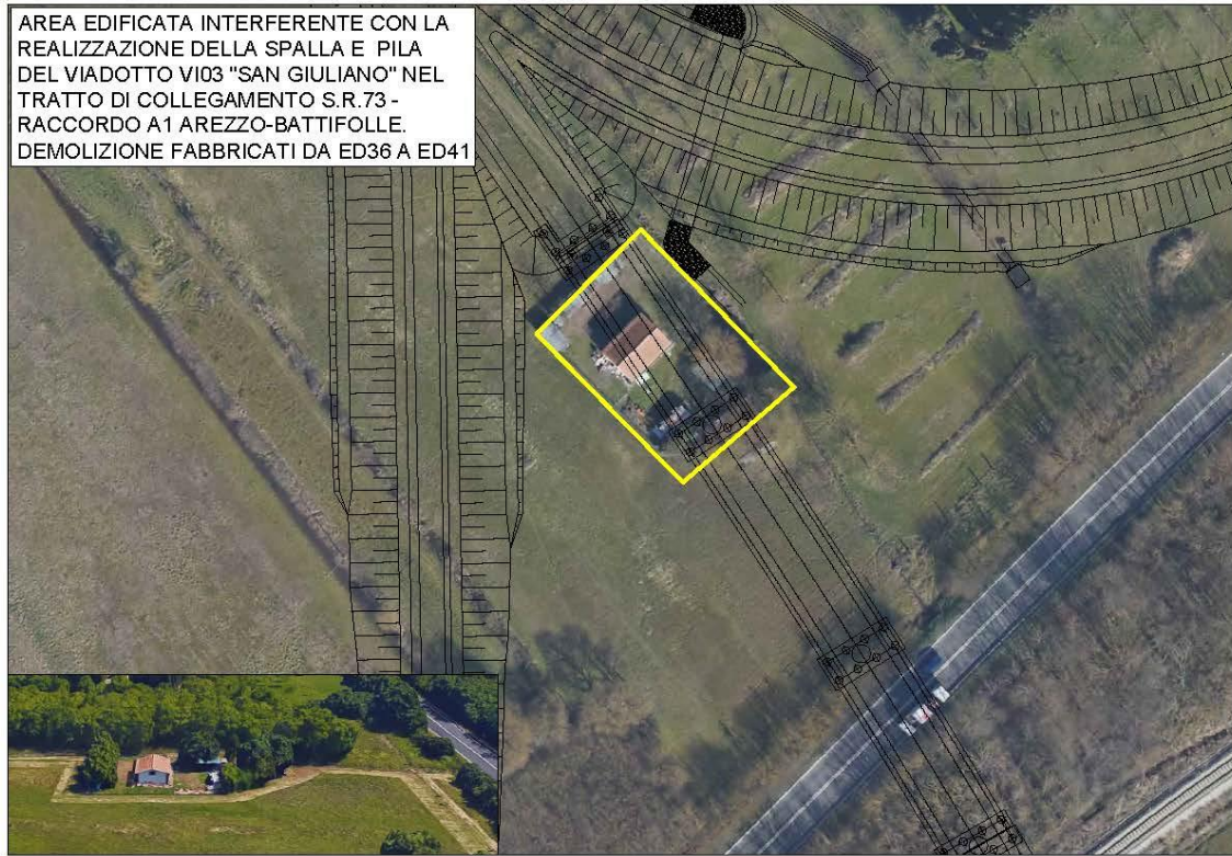
Figura 9.1 – Demolizione fabbricati da ED36 a ED41 lungo Viadotto San Giuliano
