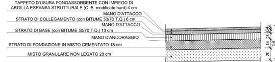
Viabilità - CAT. C1/C2 : PARTICOLARE PAVIMENTAZIONE
