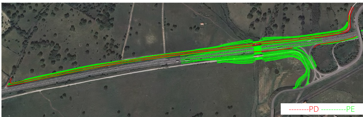
Figura 2.5.3-9 – S21_ Risoluzione accessi al Km 127+000
