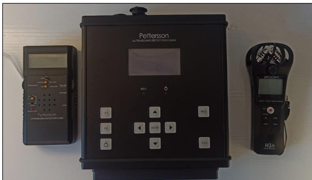
Figura 31 – Attrezzatura utilizzata per il monitoraggio chiroteri. Da sinistra: rilevatore a eterodina ed espansione temporale (x10 e x20 selezionabile), Bat detector D 500X per la registrazione prolungata nel campo degli ultrasuoni, e registratore multitraccia collegato al D 240 X
