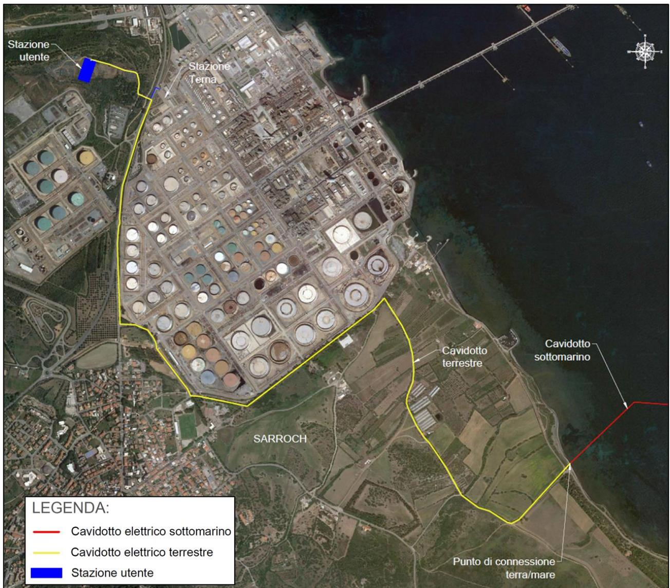
Figura 5-20 – Vista aerea del percorso del cavo di terra
