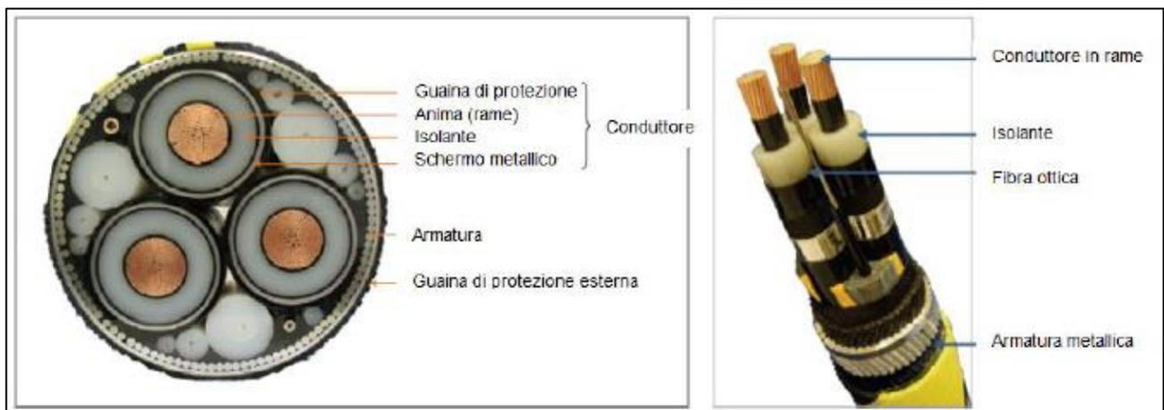
Figura 5-12 – Esempio di cavo di connessione
