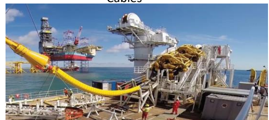
Figura 22 - Particolare dell'imbarcazione posa cavi - NKT Cables
