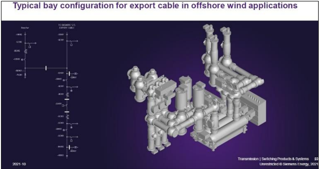
Figura 18 - Schema di configurazione di collegamento del cavo di trasporto alla stazione off-shore (fonte Siemens)
