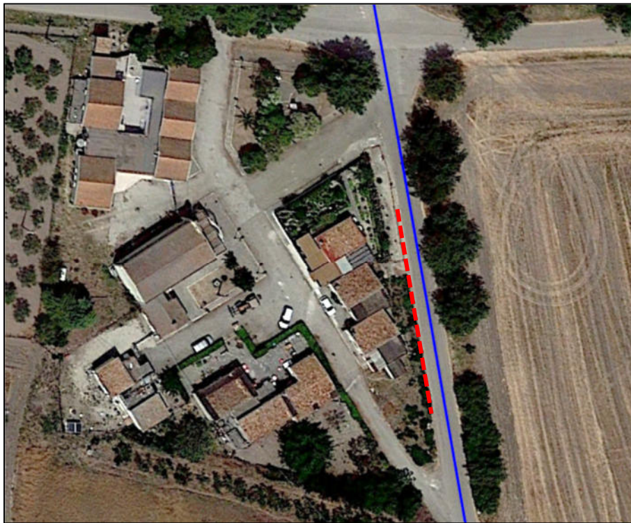
Fig. 19: Ricettori prossimi alle aree di scavo del cavidotto (distanza ca. 10 metri) e posizionamento barriere di cantiere in rosso
