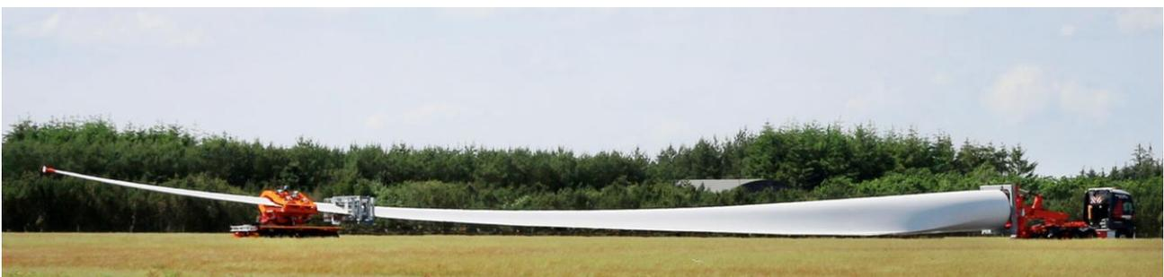
**Figura 22** – Esempio di trasporto con "RBTS" (Rotor Blade Transport System)
