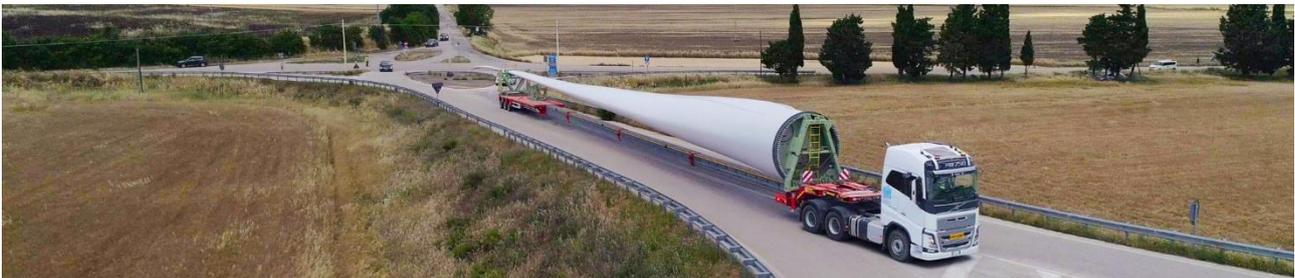
**Figura 21** – Esempio di trasporto con SWC (Super Wing Carrier)
