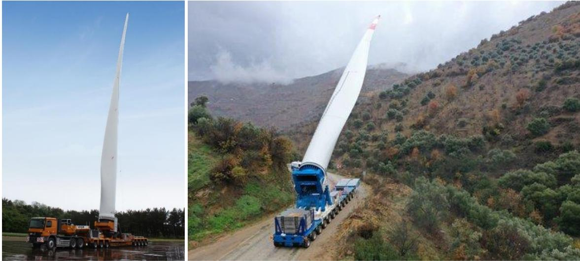
**Figura 23** – Esempio di trasporto con Blade Lifter Trailer
