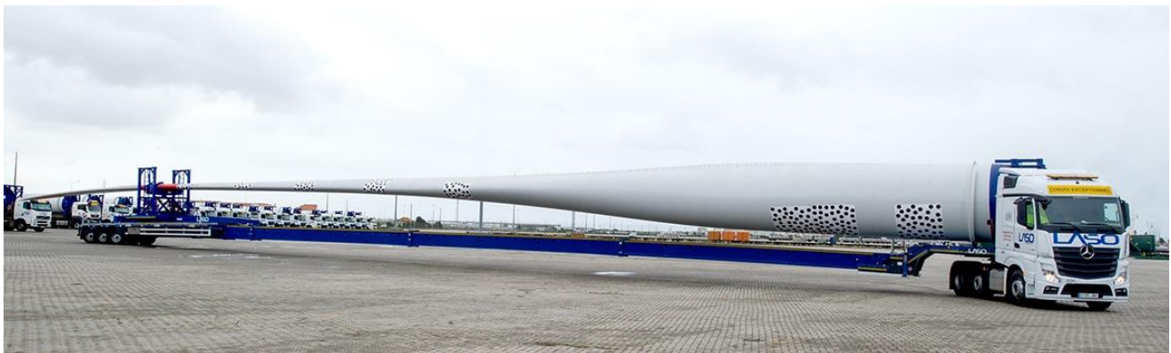
Figura 1 Esempio di trasporto pale con tipologia SWC
