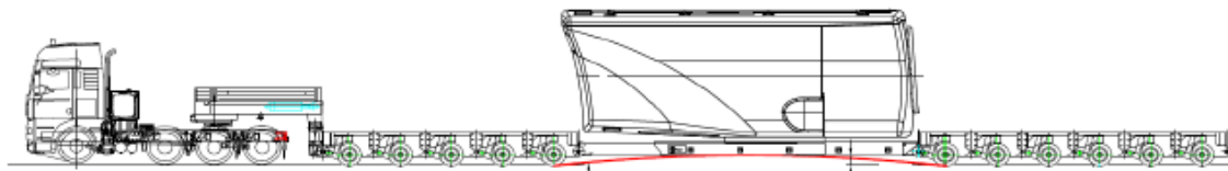
Figura 8 Schema tipo per il trasporto della navicella
