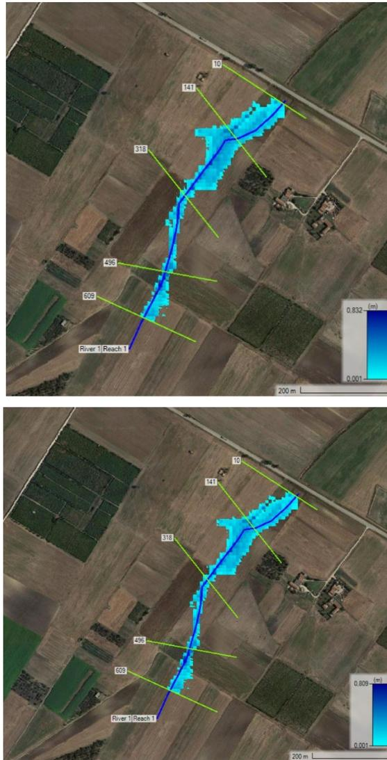
Figura 12 – altezze del tirante idraulico alla portata considerata con TR = 30, 200, 500
