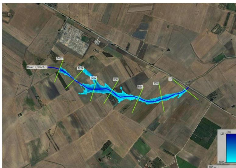
Figura 9 – altezze del tirante idraulico alla portata considerata con TR = 30, 200, 500
