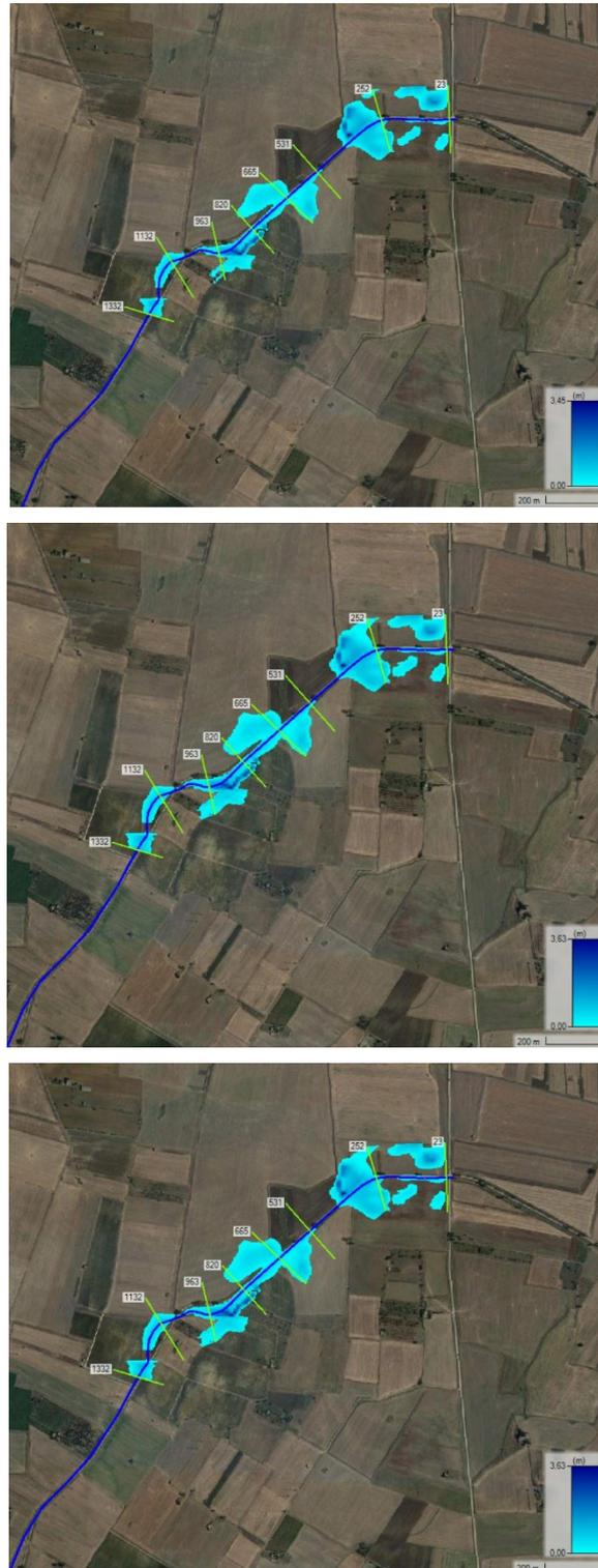
Figura 18 – altezze del tirante idraulico alla portata considerata con TR = 30, 200, 500
