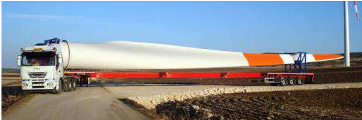
Figura 113 - Soluzione tipo del trasporto delle pale e pista di nuova realizzazione tipo per l'accesso alla turbina
