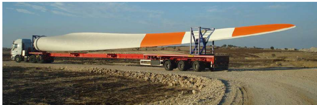
Figura 114 - Soluzione tipo del trasporto delle pale e adeguamento in curva tipo sulla viabilità esistente
