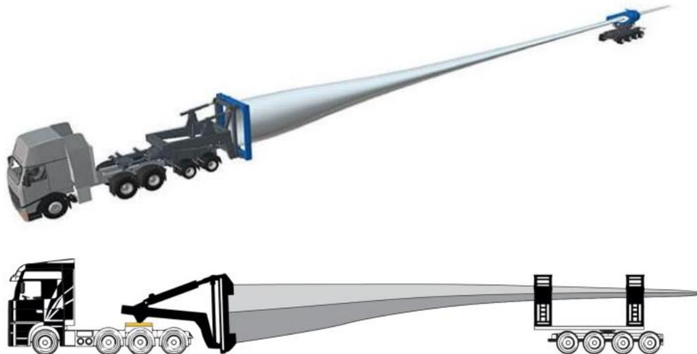
*Figura 6 – Esempio di trasporto pale tipologia RBTS*
