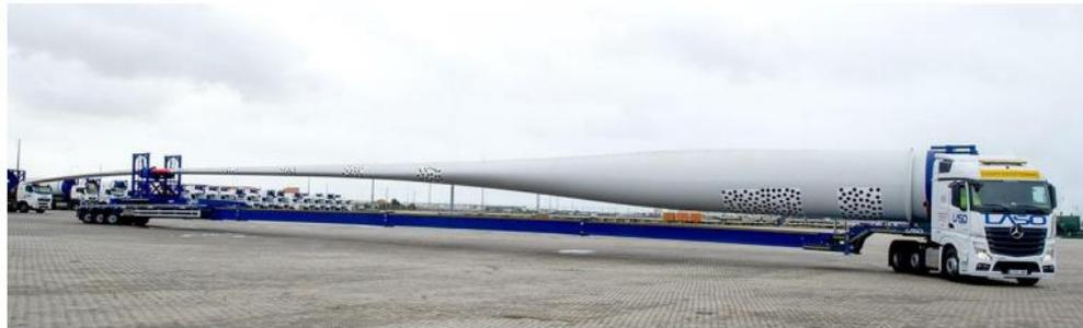
*Figura 5 – Esempio di trasporto pale tipologia SWC*
