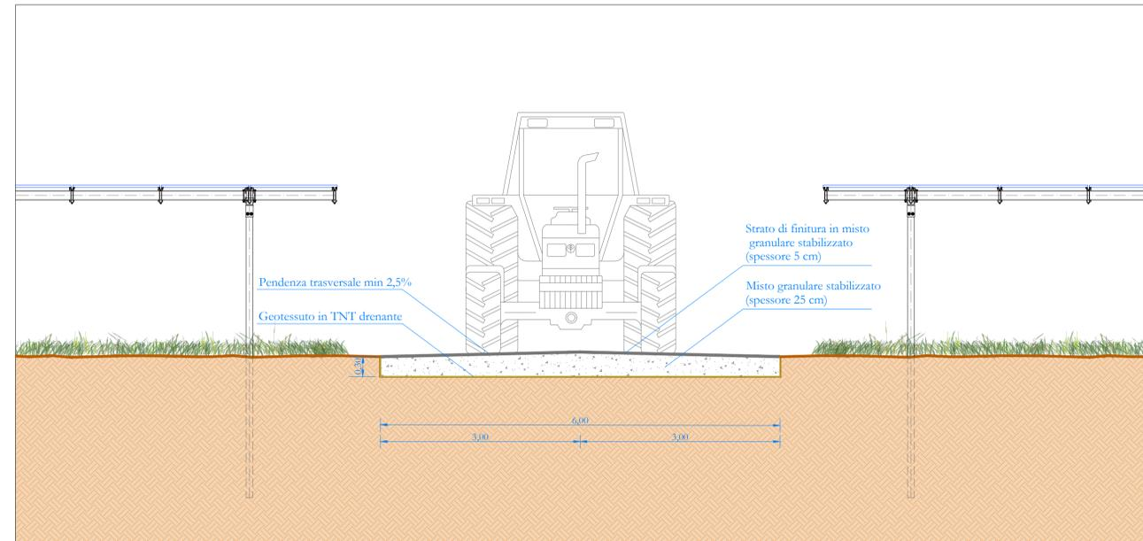
Particolare sezione stradale tipo\_Scala 1:50
