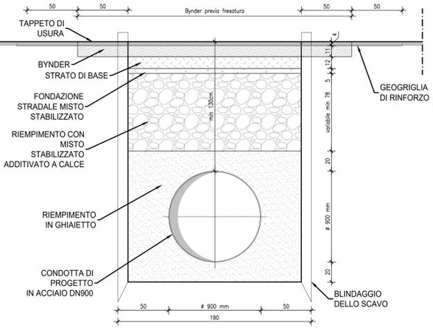
TITOLO: Particolari costruttivi: sezioni tipo di scavo e ripristini
